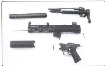
拆開護木，旋轉鬆脫減音管，即可完成大部分解
