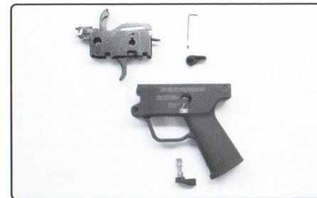
完成扳機組件取出
